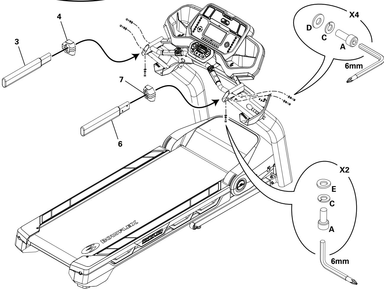
7. Защелкните верхние и нижние крышки узла соединения на своих местах и зафиксируйте их на раме в сборе с помощью металлических крепежных изделий
